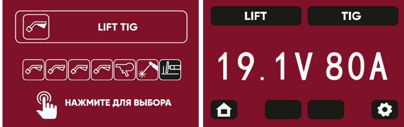
На экране отобразится заданный сварочный ток LIFT TIG. Его можно отрегулировать, вращая правую ручку (3).
