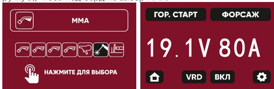
На экране отобразится заданный сварочный ток MMA. Его можно отрегулировать, вращая регулятор параметров сварки (3).
