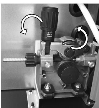
4.1.2.2 Проверьте, что прижимной ролик (16) соответствует выбранному типу и размеру проволоки.
