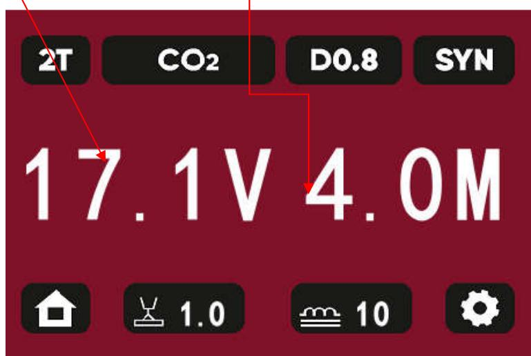
5.1.5.3 Чтобы самостоятельно откорректировать сварочное напряжение, поверните левую ручку (1). Изменение сварочного напряжения отобразится на дисплее как показано ниже .
