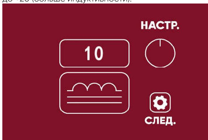
индуктивность регулирует интенсивность сварочной дуги, что делает дугу «более мягкой», с меньшим количеством брызг при работе. Высокая индуктивность дает большую глубину проплавления. Оптимальные настройки индуктивности зависят от многих переменных сварки, таких как: тип материала, тип защитного газа, сварочный ток, диаметра проволоки.
