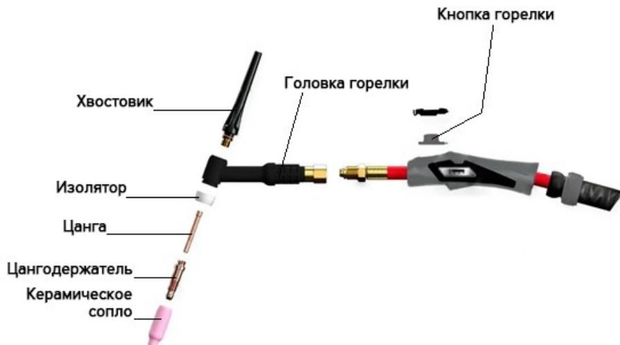
*\*Опционально сварочные горелки КЕДР TIG EXPERT могут оснащаться кнопками с регулировкой параметров (рабочего тока) на рукоятке.*
