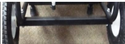
3. Установите широкие пневматические колеса и шины с помощью блокирующей гайки с капроновой вставкой.
