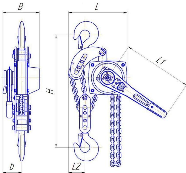
Обозначенные на схеме размеры для тали ТРШСРп-3,2 в мм:  $H=570$ ;  $B=190$ ;  $b=115$ ;  $L=270$ ;  $L1=320$ ;  $L2=80$ .
