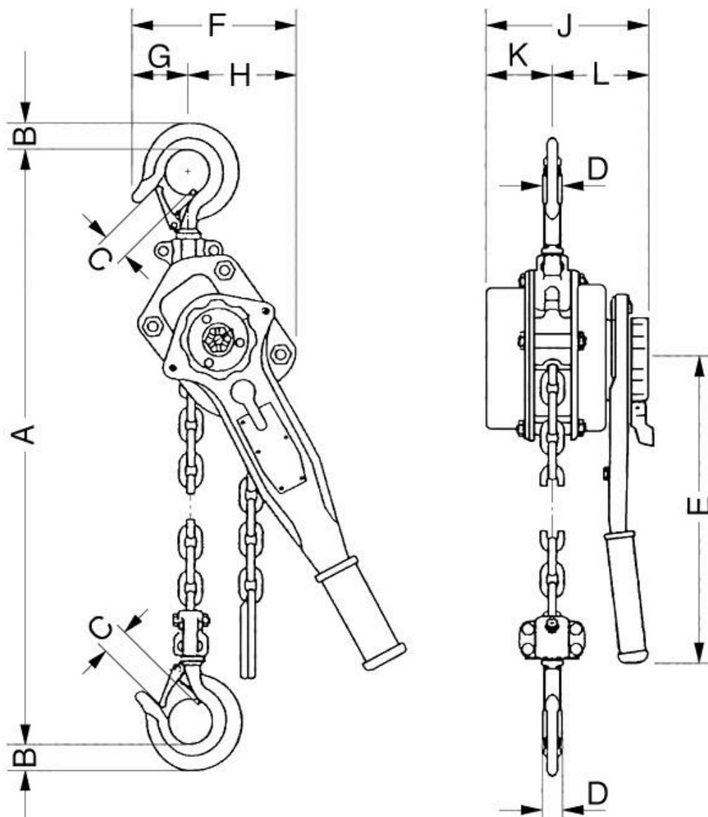
Обозначенные на схеме размеры, мм: A=340; B=22; C=26; D=16; E=250; F=150; G=70; H=80; J=150; K=60; L=90.
