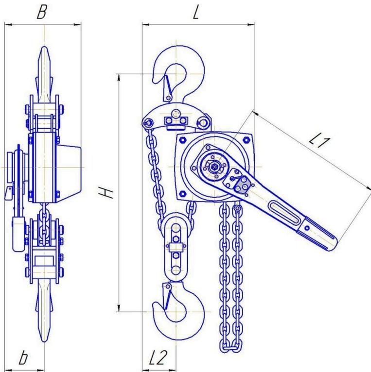
Обозначенные на схеме размеры для тали ТРШСРп-2,0 в мм:  $H=500$ ;  $B=180$ ;  $b=115$ ;  $L=255$ ;  $L1=320$ ;  $L2=80$ . Таль ручная рычажная ТРШСРп-2,0 состоит из: механизма тали с верхней подвеской; грузовой круглозвенной цепи; нижней подвески; рычага.
