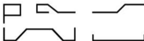
Рис. 5 Формы изгиба арматуры
