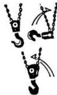
Рис. 6 Неправильное положение крюка.
