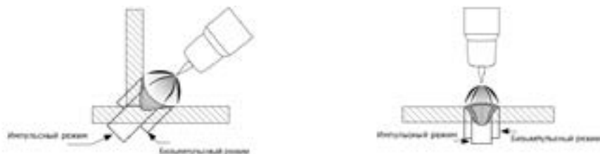
Рис. 8.10. Выделяемое тепло в импульсном и безимпульсном режимах.
