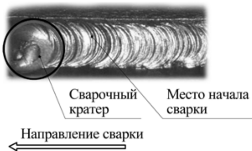
Рис. 9.4. Начало сварки при смене электрода.
