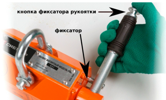
Рисунок 3. Порядок работы с магнитным захватом.
